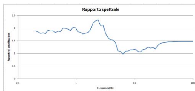
Dall'alto: Funzione di Trasferimento, funzione FFT e rapporto spettrale di amplificazione.
