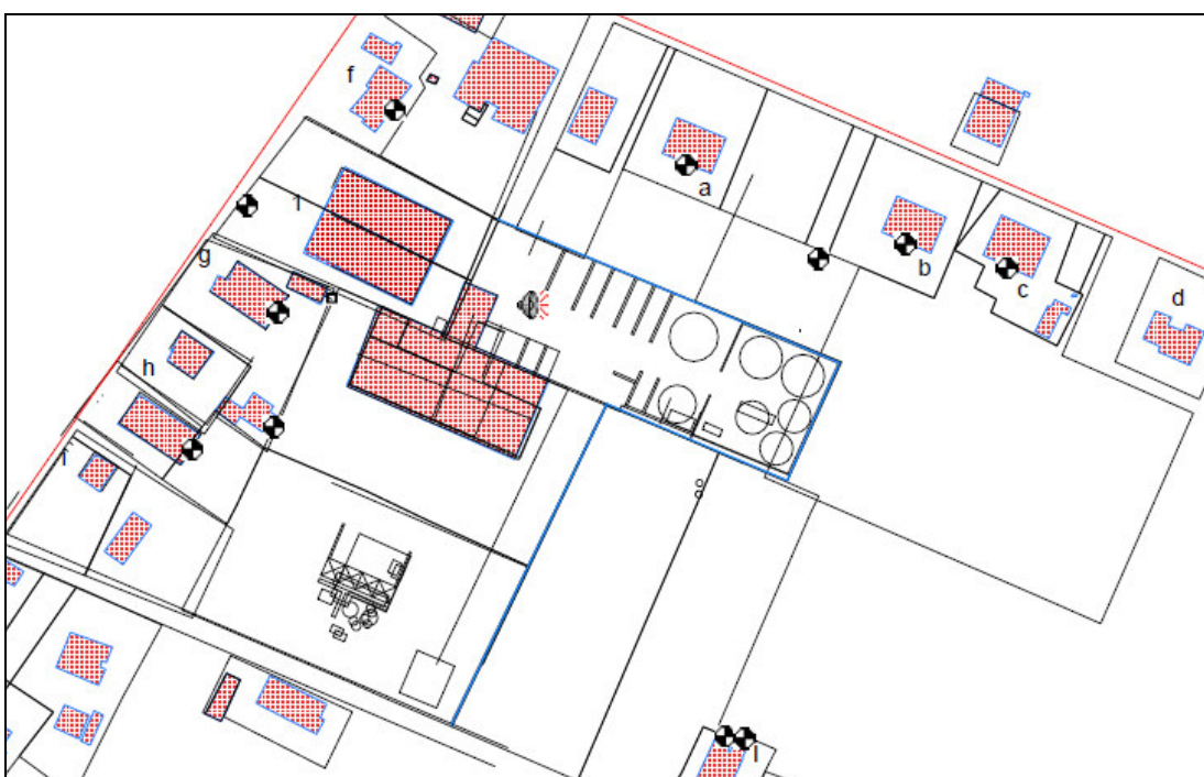
Pianta posizione sorgente - L'altoparlante indica la posizione del mezzo per il carico materie prime con pala, i pallini la localizzazione del bersaglio relativo al calcolo puntuale
