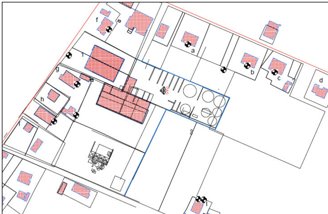
Pianta posizione sorgente - L'altoparlante indica la posizione del mezzo per lo scarico materie prime con pala, i pallini la localizzazione del bersaglio relativo al calcolo puntuale
