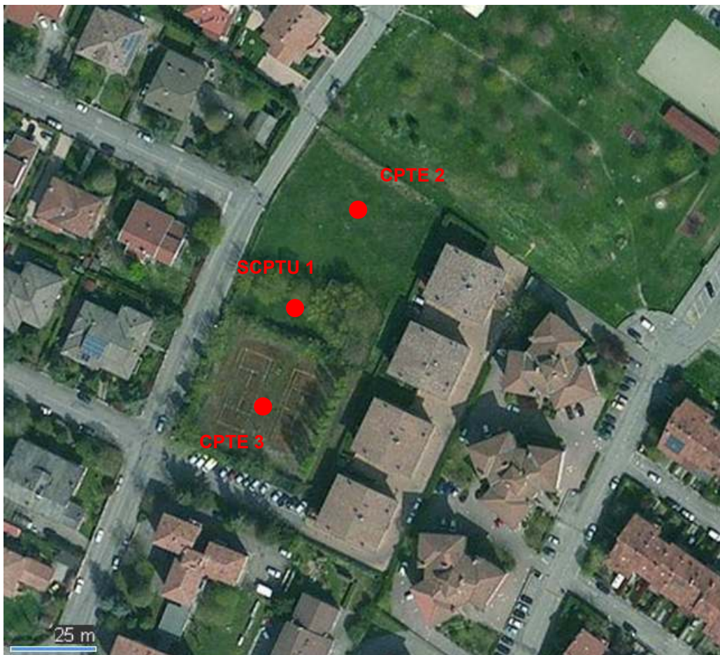
Figura 5.1: ubicazione prove penetrometriche
