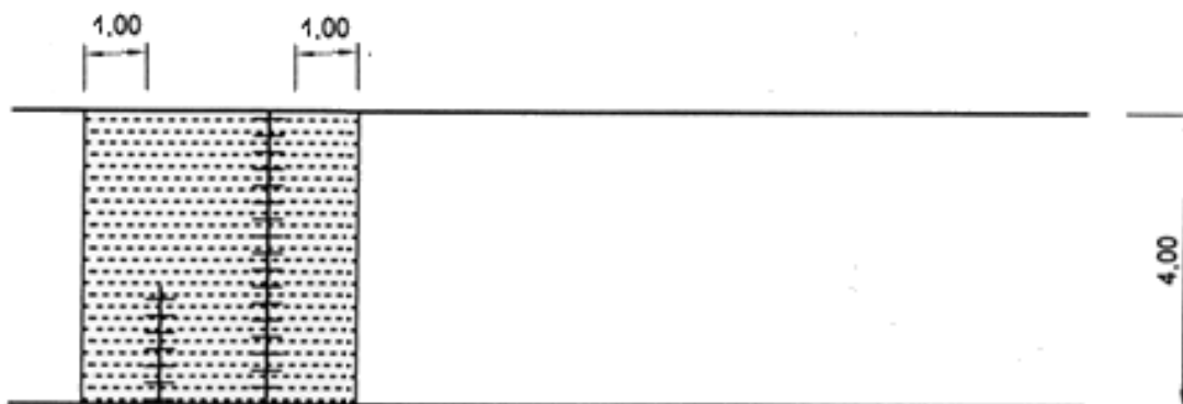
figura 4 doppio scavo trasversale alla carreggiata
